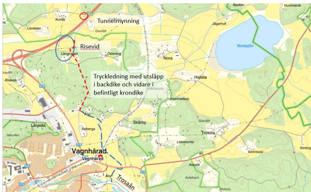
Figur 12. Figuren visar hur det behandlade vattnet vid Risevid kan pumpas i tryckledning (röd streckad linje) söderut över vattendelaren och vidare med självfall i befintliga diken (blå streckad linje) till Trosaån.
