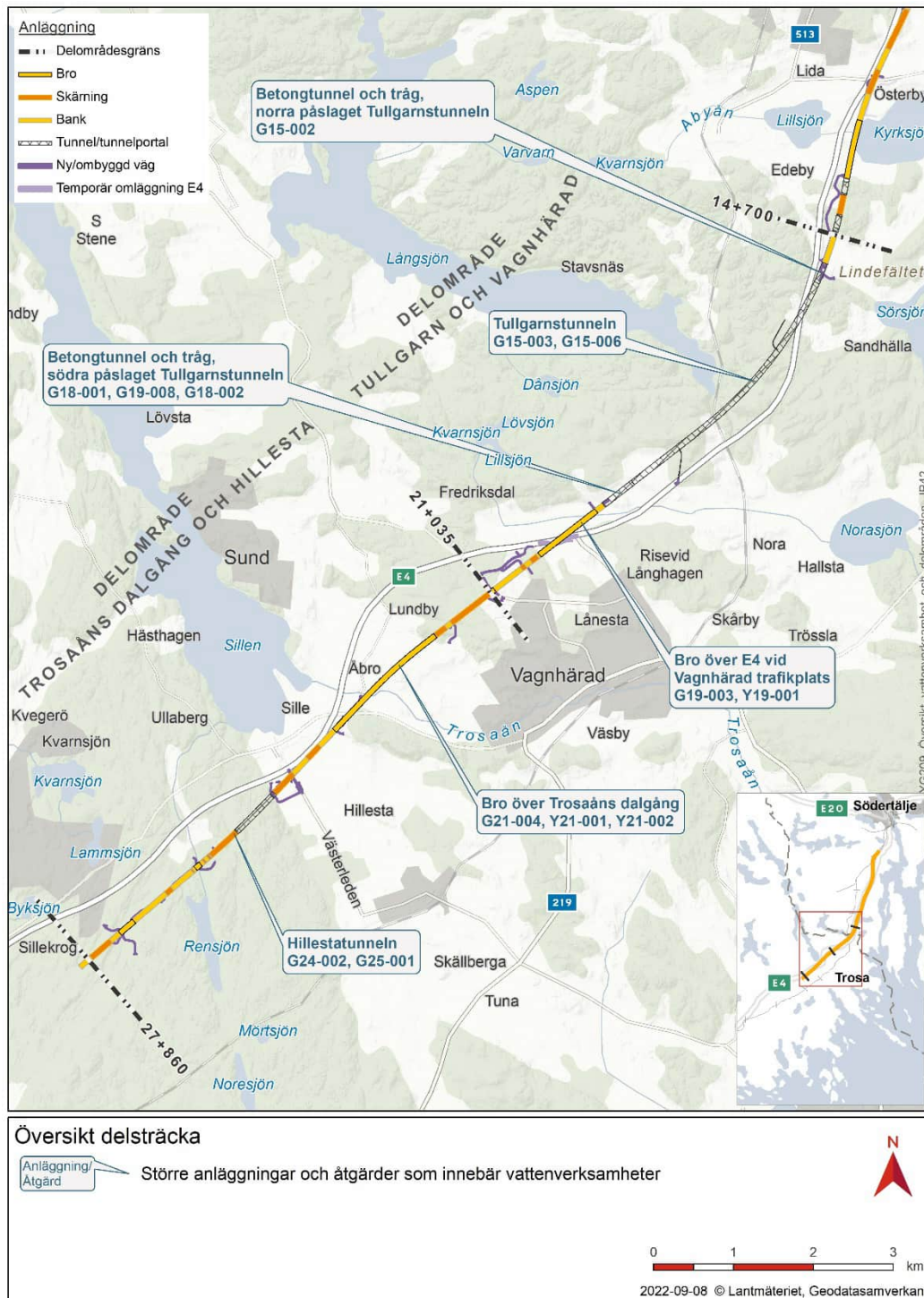
Figur 15: Översikt över järnvägsanläggningen Ostlänken, delen Långsjön–Sillekrog, (bro, skärning, bank och tunnel) samt större anläggningar och åtgärder som innebär vattenverksamhet. Däremellan förekommer mindre skärningar, trummor i diken, med mera ID numren i pratbubblorna anger ID för de större vattenverksamheter som planeras vid utpekade anläggningsdelar.
