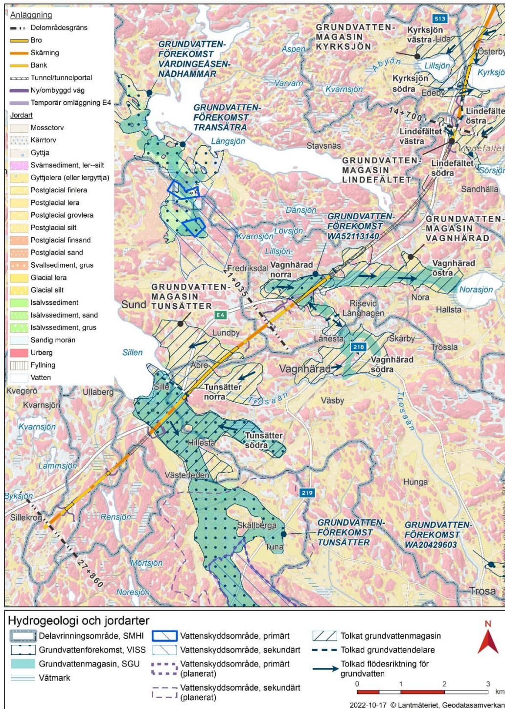
Figur 14: Hydrogeologi och jordarter längs delsträckan Långsjön–Sillekrog. Gränser för delområden anges med streckad linje med tillhörande km-angivelse, se beskrivning av delområden i avsnitt 6.4.
