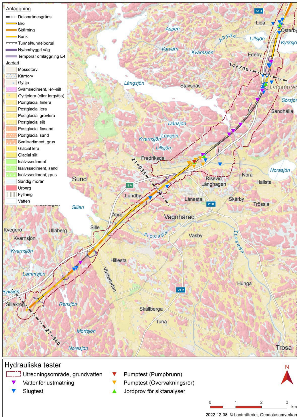
Figur 9: Utförda hydrauliska tester och jordprover där hydraulisk konduktivitet utvärderats. Slugtester har utförts i observationsrör.
