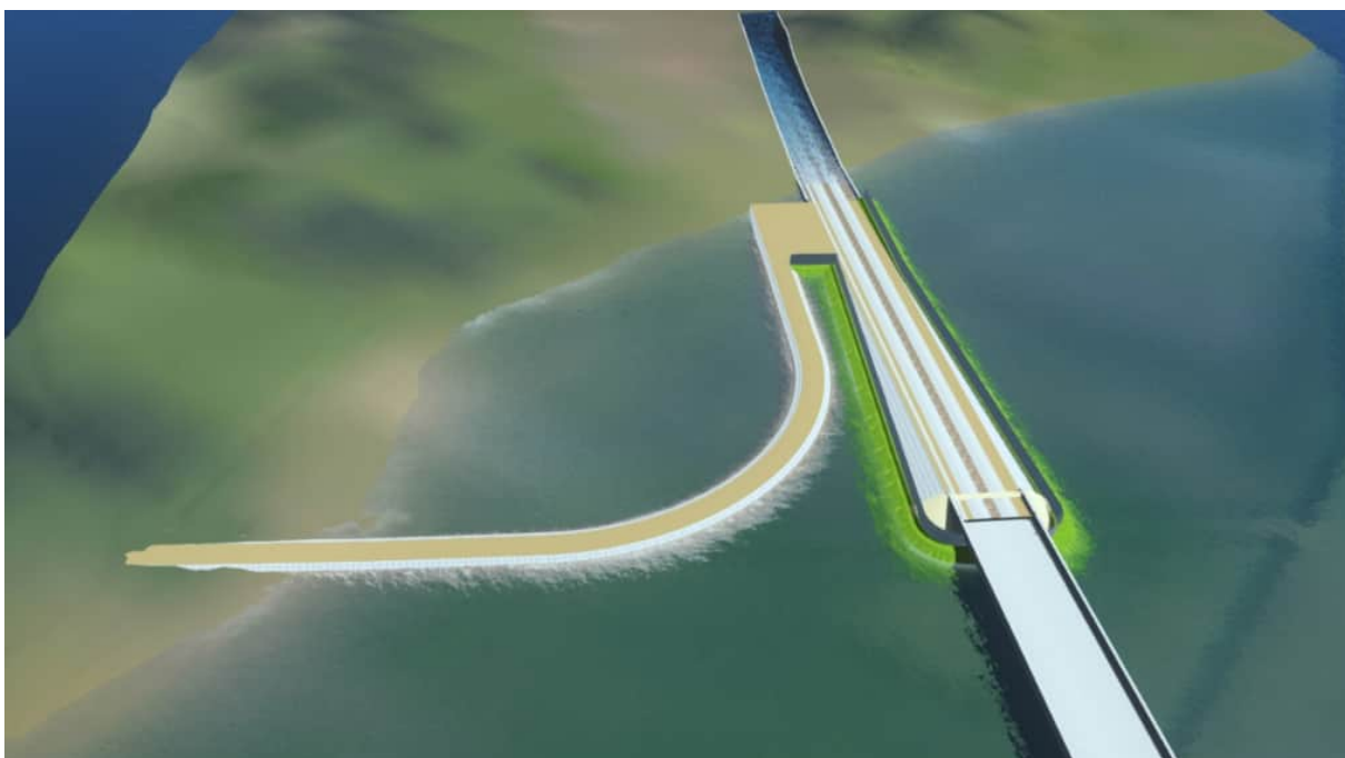
Figur 29 Alternativ lösning: Skiss med tät vall integrerad i banvallen med krönnivå på ca. +14,00 m.
