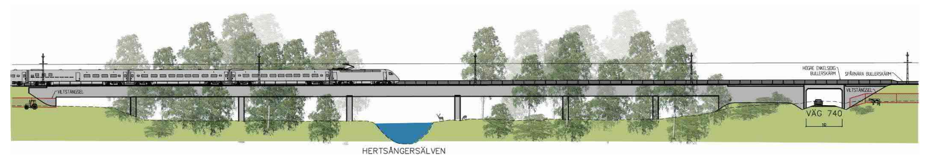
Figur 5.2-12 Järnvägen på landskapsbro över Hertsångersälven och väg 740, km cirka 70+400.
