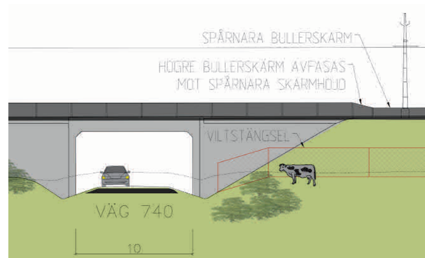
Figur 4.2-26. Illustrativ elevation över övergång från bullerskärm, höjd 1,2 m, mot spårnära bullerskärm höjd 0,7 meter.
