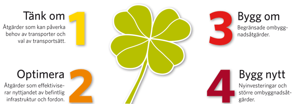
Figur 3. Schematisk illustration över fyrstegsprincipen. Källa: Trafikverket
