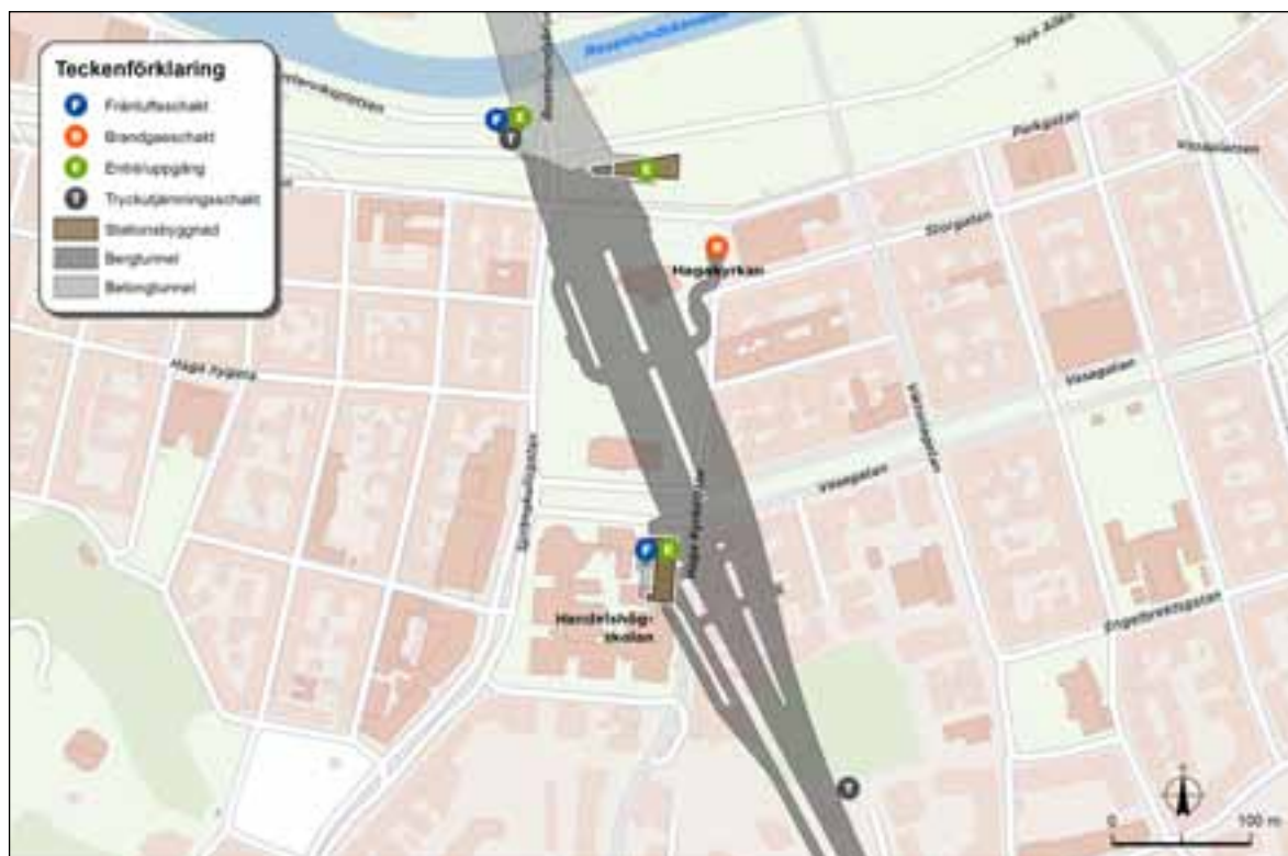
FIGUR 3.61. Station Haga, ovanjordsanläggningar.
