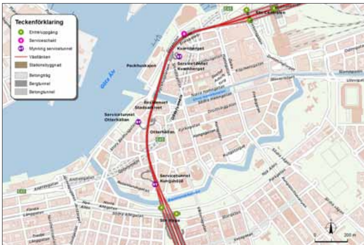
FIGUR 3.31. Ett serviceschakt och tre servicetunnlar byggs mellan Station Centralen och Station Haga.
