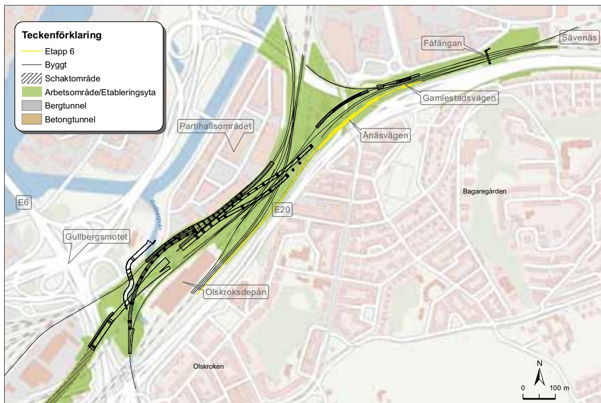
FIGUR 1.7. Översikt över etapp 6. Bland annat anläggs bron över Anäsvägen och bron över Gamlestadsvägen byggs om.
