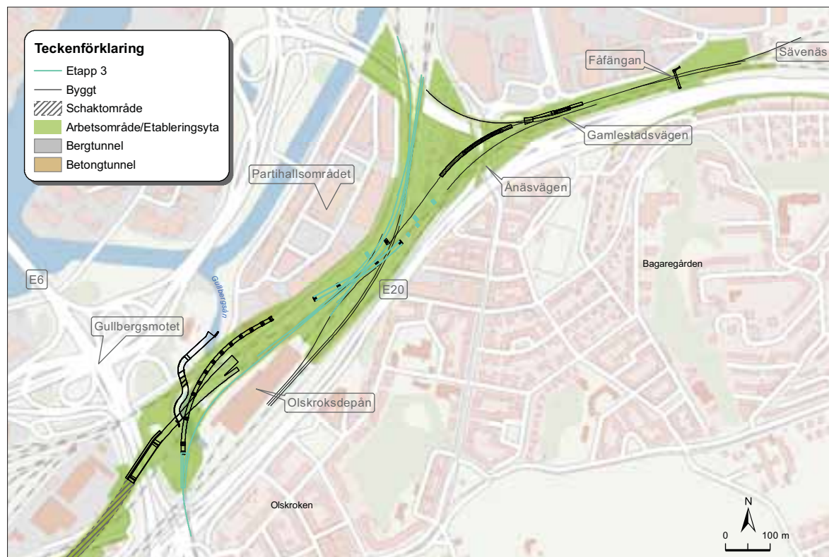
FIGUR 1.4. Översikt över etapp 3. Arbetet med de två enkelspårsbroarna fortsätter och godstågsviadukten ansluts till den befintliga godsspårsgrenen.
