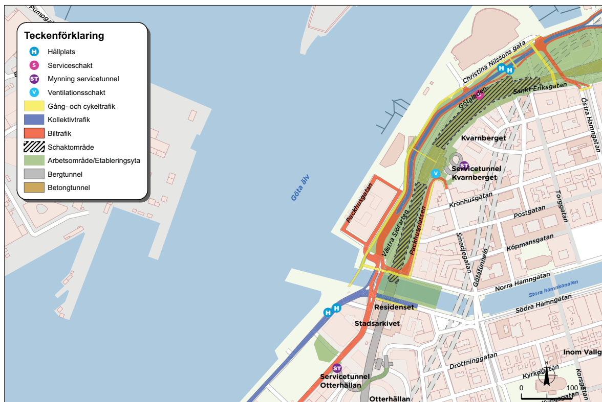
FIGUR 1.14. Översikt över arbetet mellan Station Centralen och Residenset. Utförande av resterande schakter.
