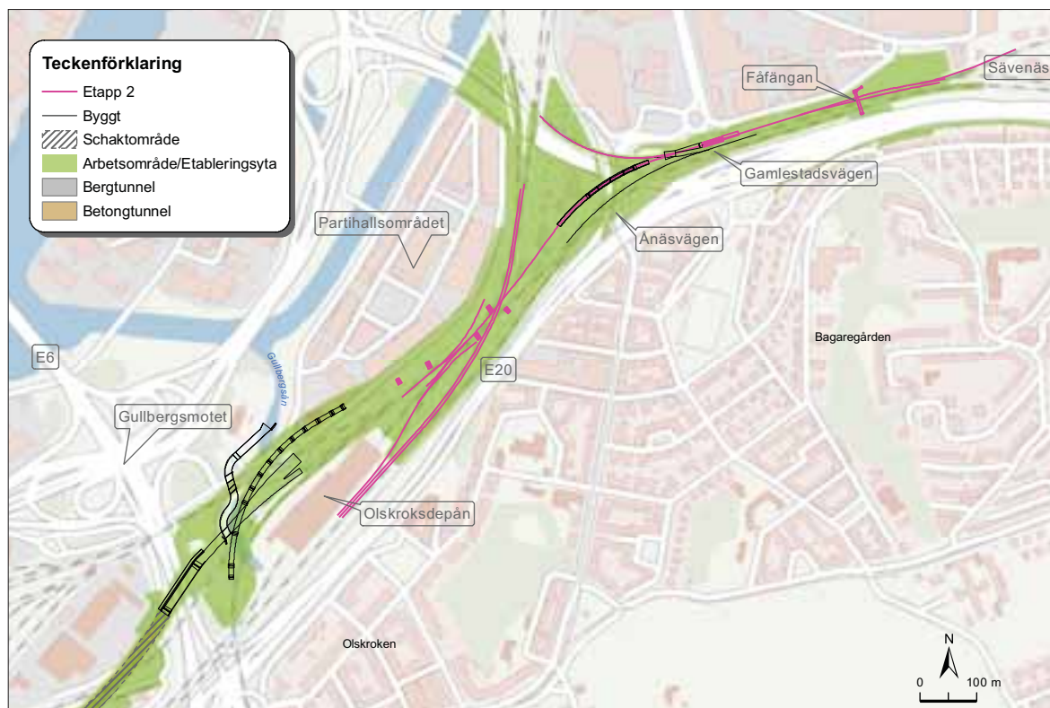
FIGUR 1.3. Översikt över etapp 2. Bland annat inleds arbetet med de två enkelspårsbroarna över Olskroken bangård.
