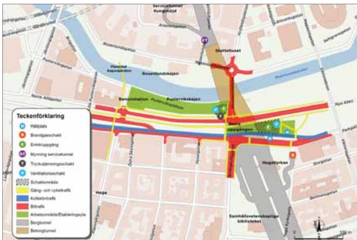
FIGUR 1.21. Översikt över arbetet med etapp 4 vid Station Haga.
