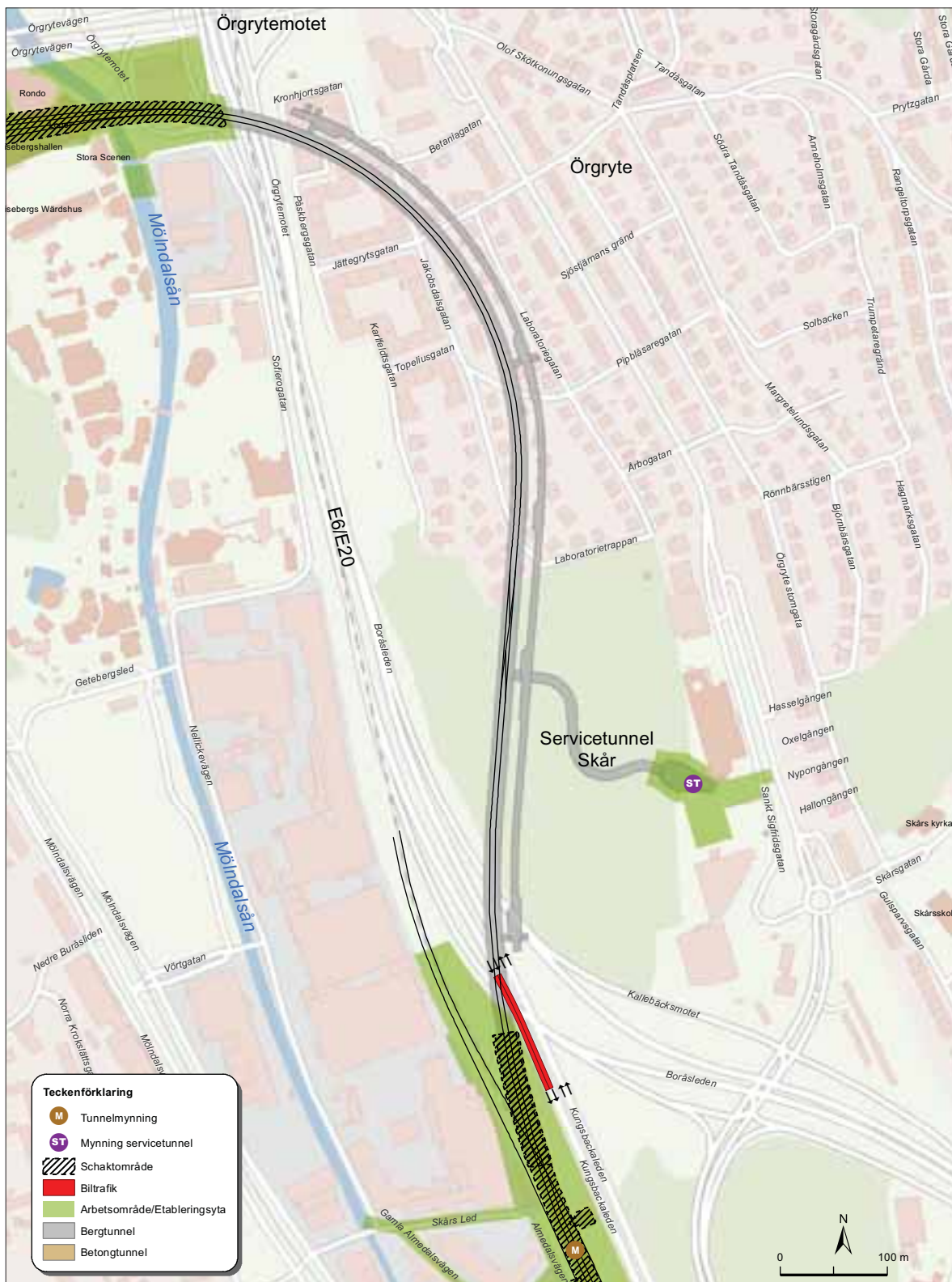
FIGUR 1.28. Översikt över arbetet med spårtunneln mellan Örgryte och Almedal.
