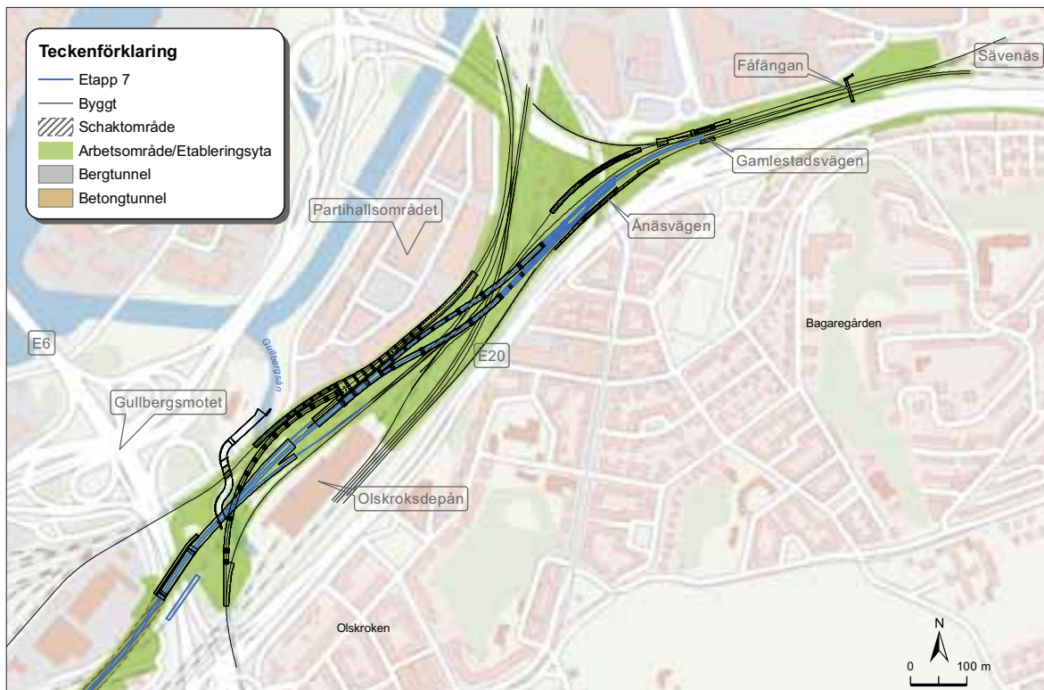
FIGUR 1.8. Översikt över etapp 7. Bland annat byggs befintlig järnvägsbro över E6 om till en vägbro och arbetet med enkelspårsbroarna över Olskroken bangård färdigställs.
