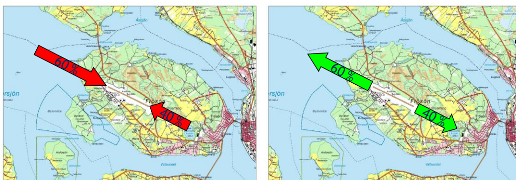
Fig. 22. I bullerberäkningen använd banfördelning för jet- och turbopropellertrafik, landningar till vänster och starter till höger
