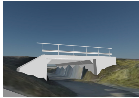
Figur 4.36 Perspektivbild från samordningsmodell: Förlängning av vägbro.
