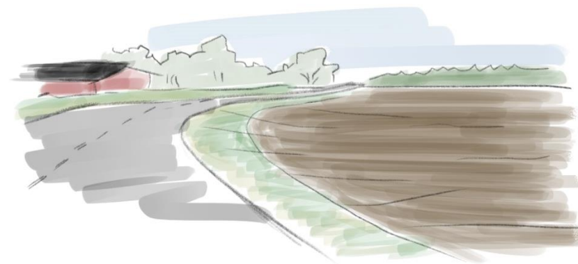
Figur 46. Flacka, brukningsbara slänter eftersträvas för att underlätta för fortsatt brukande av marken.
