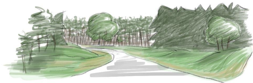
Figur 42. Mjuka övergångar mot omgivningen med varierad lutning i bakslänt ger bra landskapsanpassning. Med varsam gallring kan variation i vägrummet skapas.
