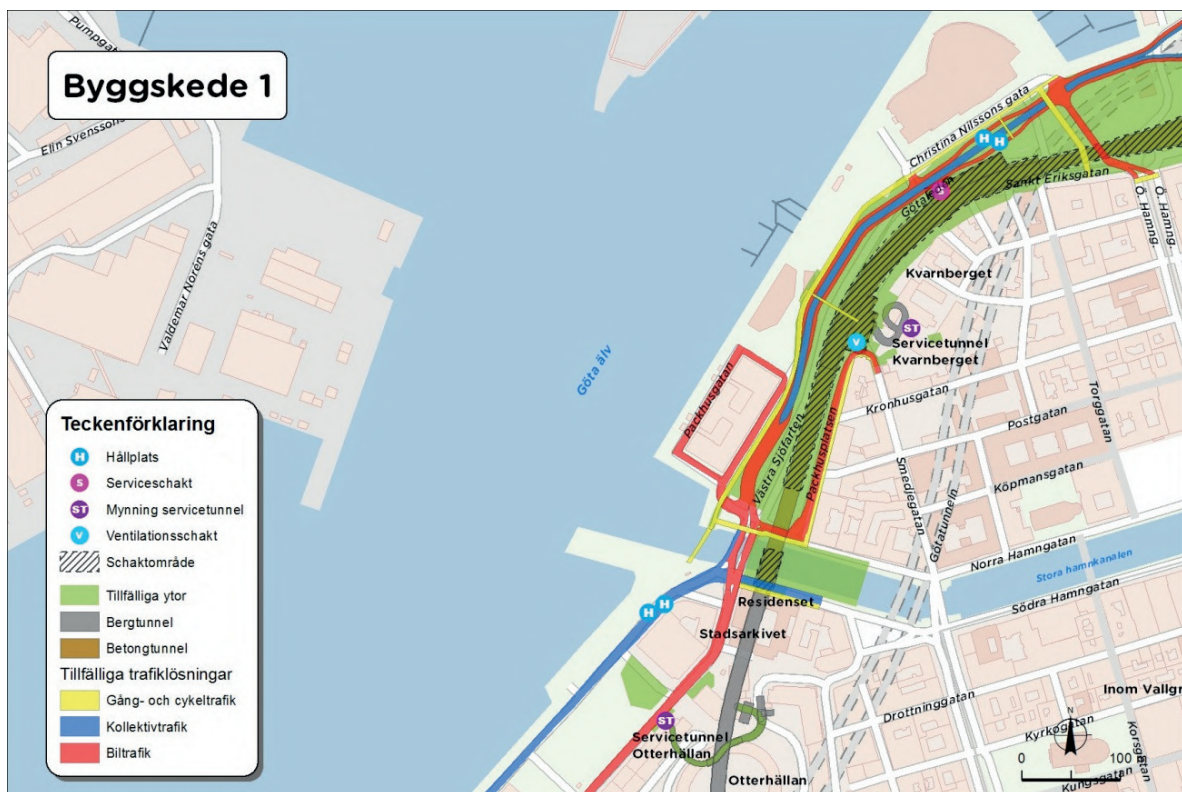
FIGUR 8.11 Illustration över byggskede 1 på delsträcka Station Centralen-Residenset.
