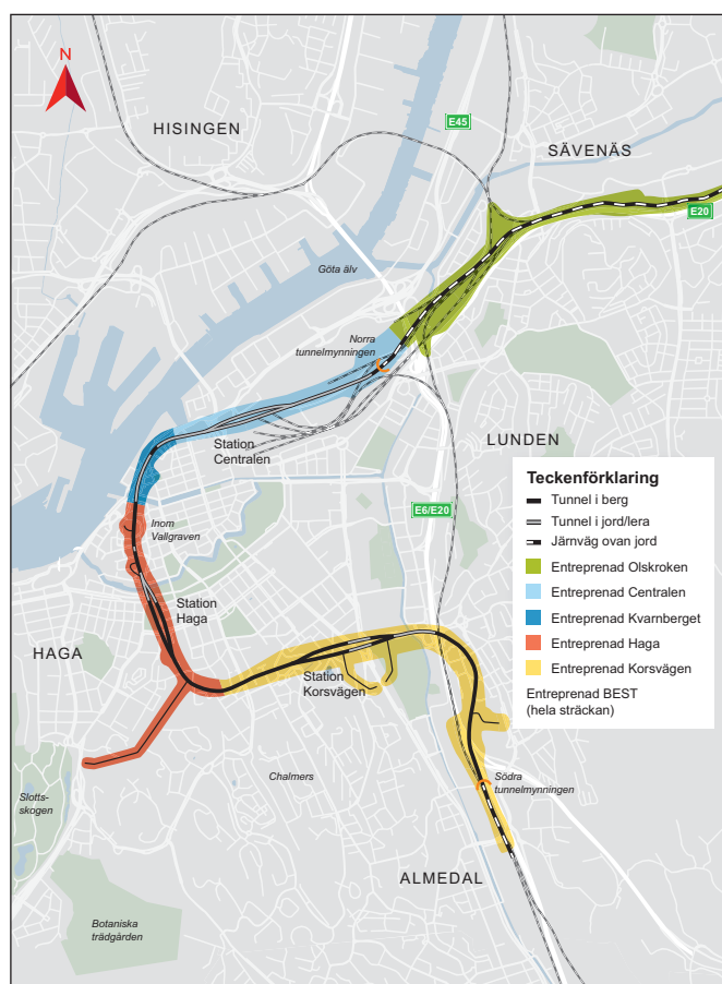
FIGUR 6.8. En tänkbar entreprenadindelning för Olskroken planskildhet och Västlänken.
