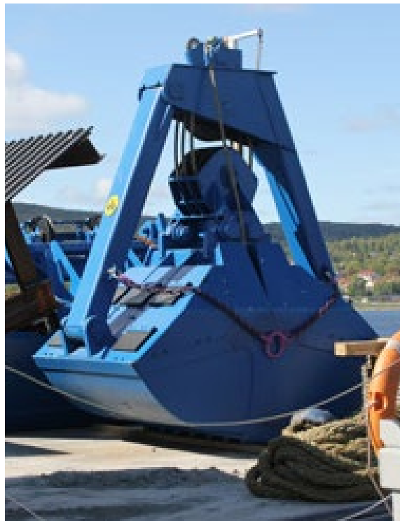
FIGUR 7.1: Schaktning bakom spont (t.v) och miljösopa (t.h.) är två metoder för att minska spridning av förorenade sediment i vatten.
