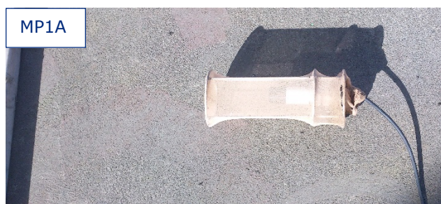
Figur 2 Hydrofon H1 med skyddsbur av kraftig ståltråd samt nylonstrumpa för att minska strömningsljudet från det strömmande vattnet i Säveån.
