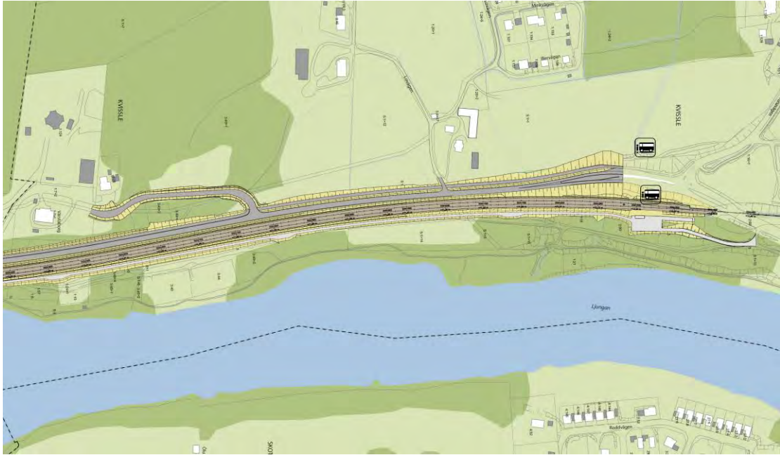
Figur 6. Karta som visar delsträckan Dingersjö-Nolby. Gamla järnvägen, tillika Nollalternativets sträckning, täcks av nya spåret.
