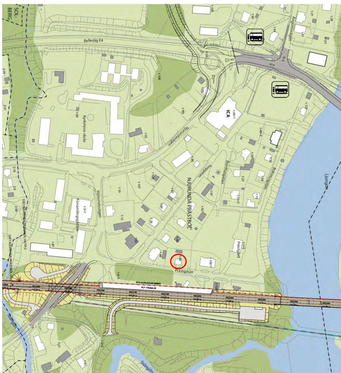
Figur 4. Karta som visar delsträckan mellan Stångån och Ljungan. Röd streckad linje markerar spårnära bullerskyddsåtgärder. Gamla järnvägen, tillika Nollalternativets sträckning, syns som svartvitrandig linje öster om ny järnväg. Ett bostadshus föreslås
