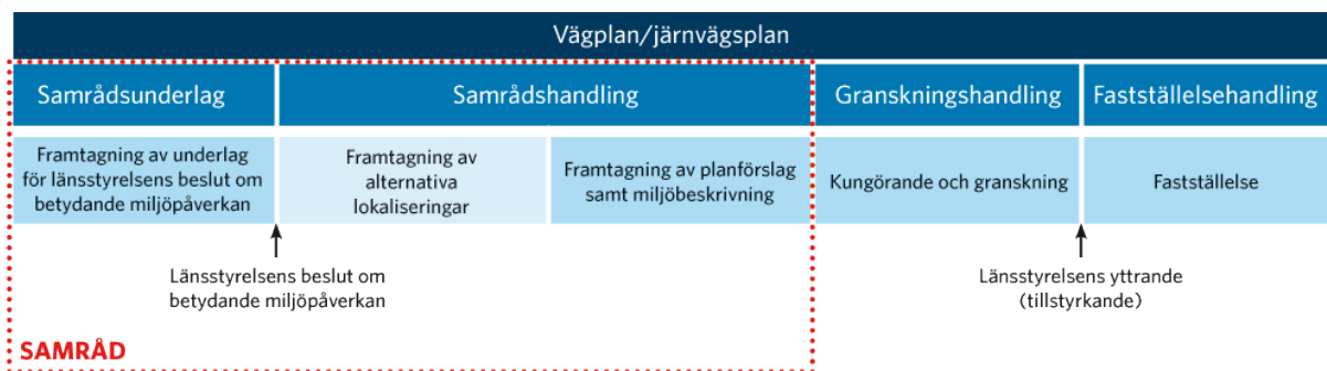
Figur 3. Planläggningsprocessen för järnvägar och vägar. Järnvägsplanen har olika status under processens gång. Aktuell järnvägsplan befinner sig nu i skede Samrådshandling. Källa: Trafikverket.
