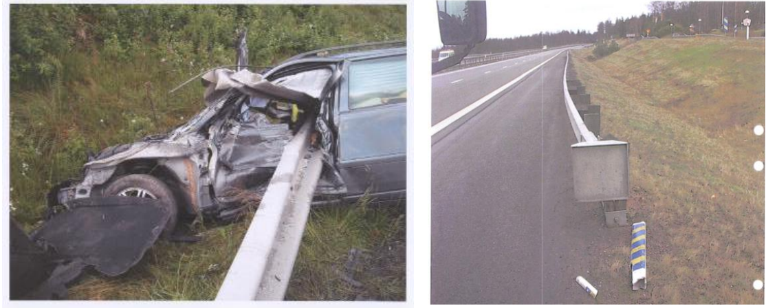
Figur 21 Exempel på sidokollision mot tvär räckesände.
