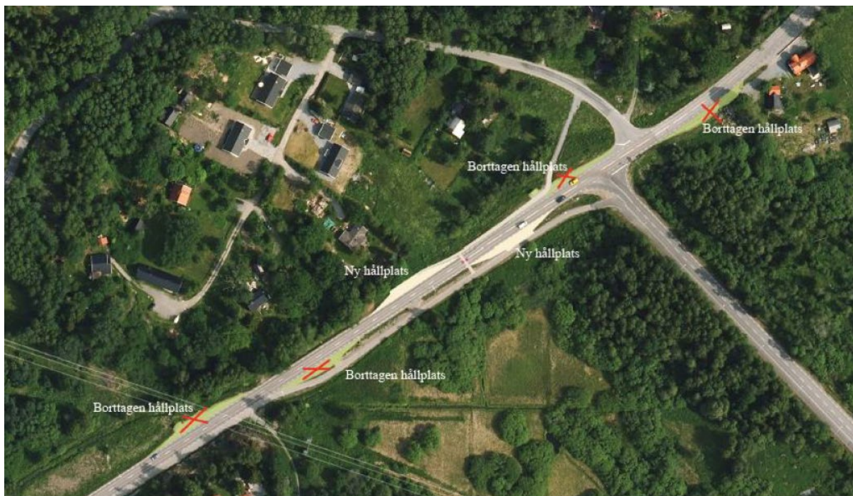
Figur 4. Den förenklade åtgärdsvalsstudiens förordade alternativ. Alternativet innebär nya hållplatslägen med refugbaserad gångpassage och att befintliga hållplatser tas bort. Källa: Förenklad åtgärdsvalsstudie Singö handel 2014-02-06, smärre åtgärder, åtgärdsnummer: 5980.
