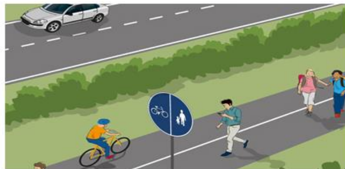
Separerad gång- och cykelbana skild från väg
