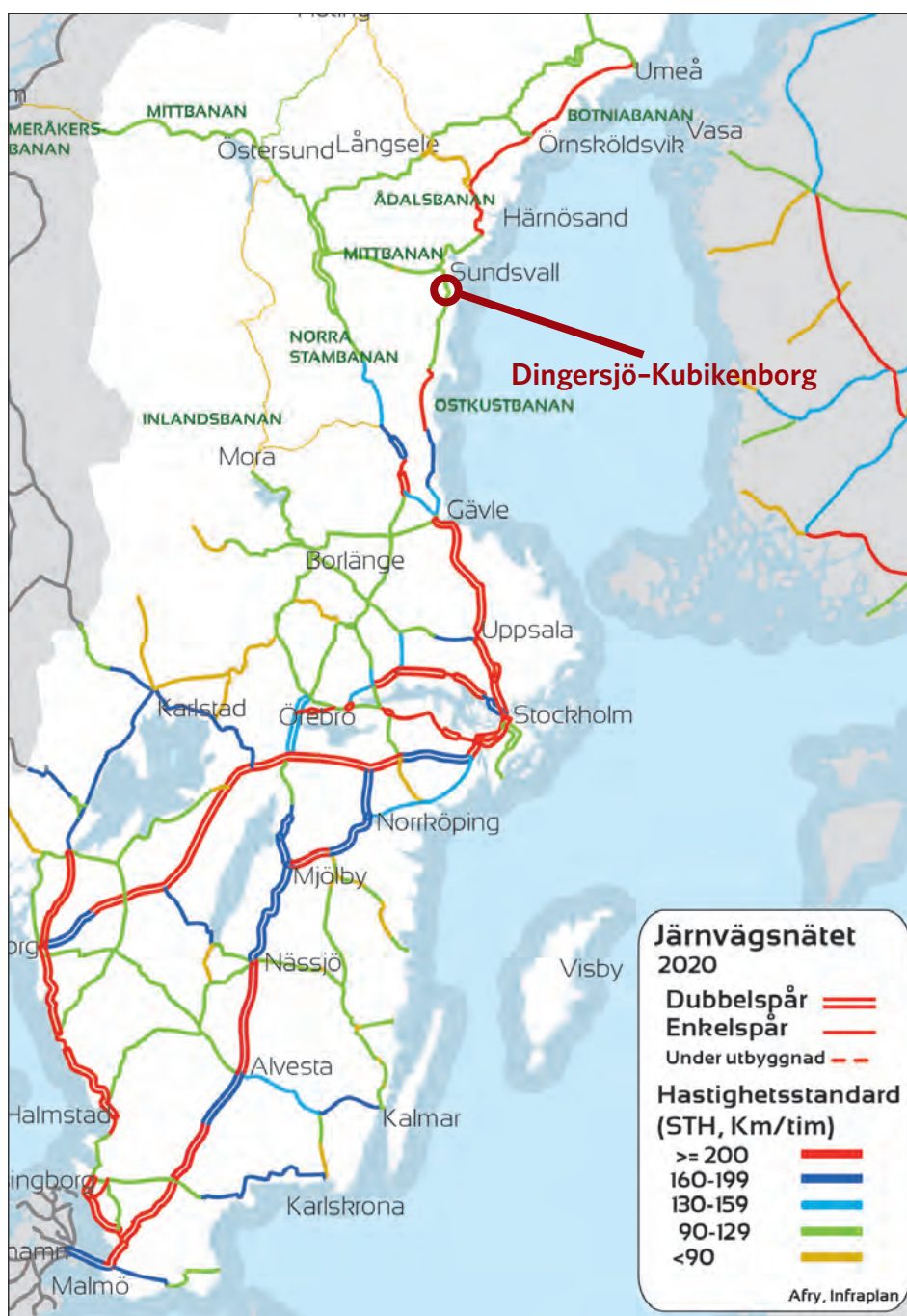
Figur 6.1:2 Ostkustbanan är enkelspärig och har delvis låg hastighetsstandard och bristande kapacitet.
