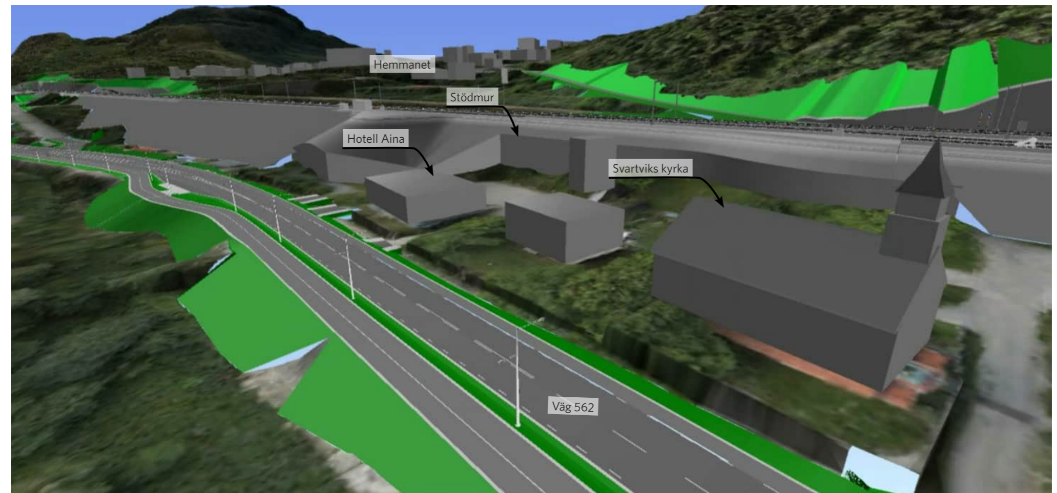
Figur 43. Vy från samordningsmodell som visar stödmuren vid som blir längs med Hotell Aina samt Svartviks kyrka.
