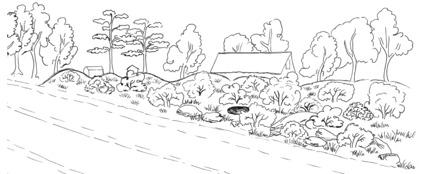
Figur 27. Skiss på utformning av bullerskyddsvall med naturligt utseende.
