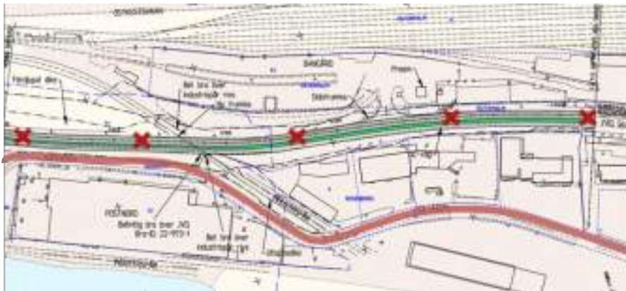
Bild 11. Rivning av bron över industrispåret i Skönsmon. Avstängningen illustreras med kryss. Omledningsvägen via Björneborgsgatan inte illustrerad. Omledningsvägen via Kolvägen delvis illustrerad med röd markering.
