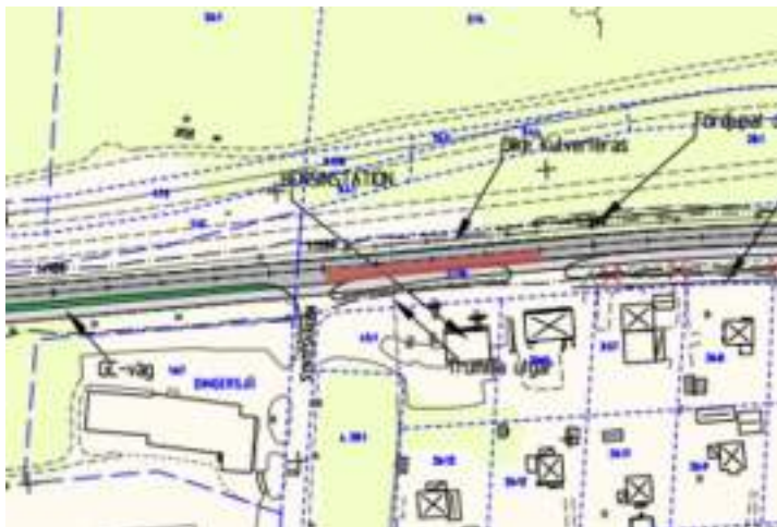
Bild 5. Kulvertering av dike i Bredsand. Den röda markeringen visar vägvägsnittet där trafiken kommer att vara förskjuten till östra halvan av vägen.
