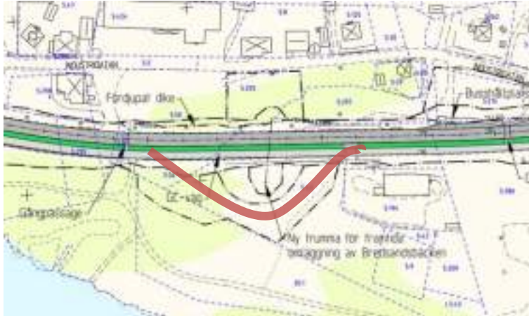
Bild 1. Trafiken leds om förbi arbetsområdet när ny vägtrumma ska schaktas ner för Nolbybäcken. Röd markering visar föreslagen omledning.
