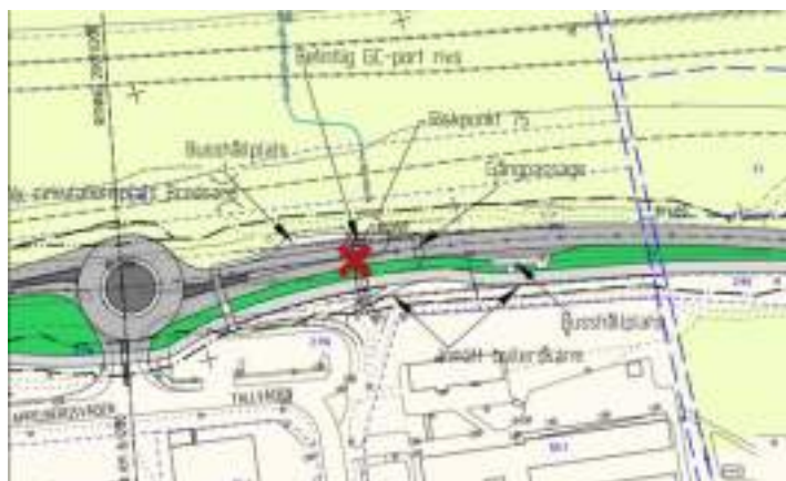
Bild 8. Rivning av gångport i Bredsand. Under arbetena behöver trafiken ledas om via trafikplats Stockvik och Skönsmon. Trafiken kan inte ledas förbi arbetsplatsen av säkerhetsskäl. Omledningsvägen via E4 inte illustrerad.
