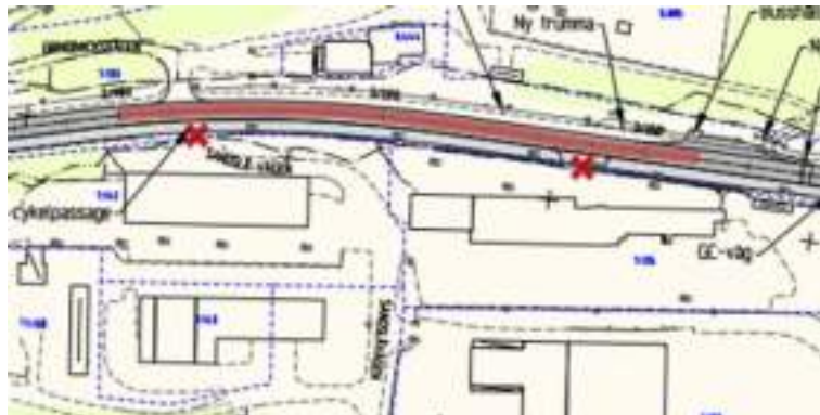
Bild 3. Sänkning av V562 vid södra Sandslåvågen. De påverkade infarterna är markerade med kryss. Den röda markeringen visar arbetsområdet där trafiken kommer att vara förskjuten till endera halvan av vägen.
