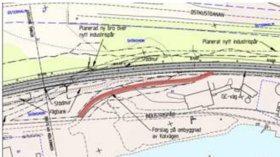
Bild 10. Ugrävning vid Kolvägen kommer att ske ovanför röd markering, där Kolvägen leds om förbi arbetsområdet.
