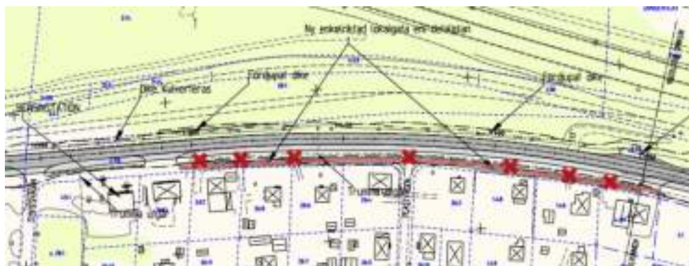
Bild 6. Ersättningsväg i Bredsand. De påverkade infarterna är markerade med kryss. Den röda markeringen visar grovt sträckningen av ersättningsvägen med nya infarter till fastigheterna.
