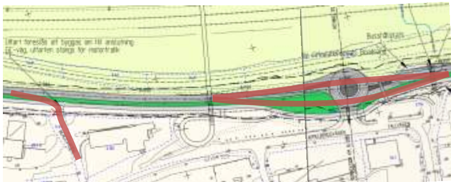
Bild 7. Den nya cirkulationsplatsen i Bredsand. Trafik till Bredsand kan välja infarten via Bergsvägen, markerad med rött till vänster i bilden. Trafiken på V562 leds genom och förbi arbetsområdet enligt markering.
