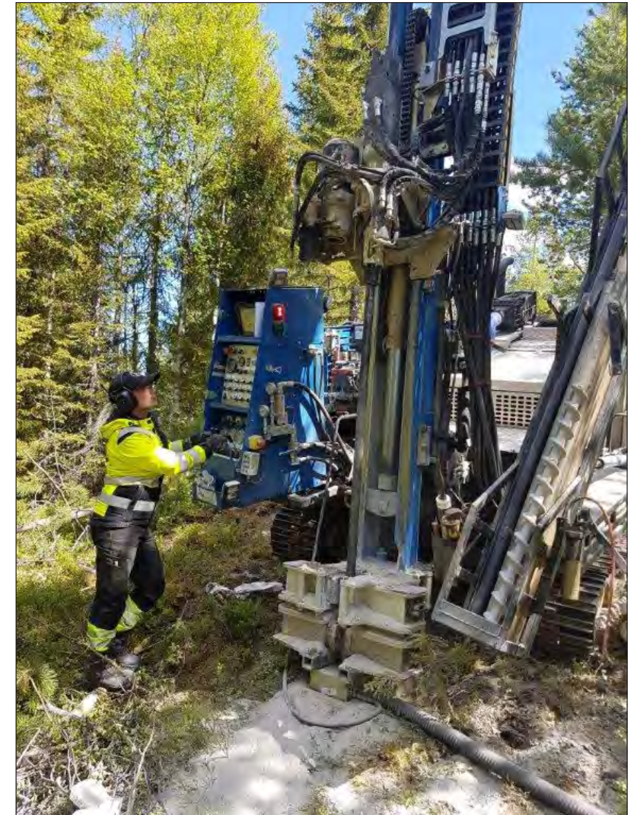
Figur 3.7:2 Borrprovtagning i fält. Foto: ÅF.
