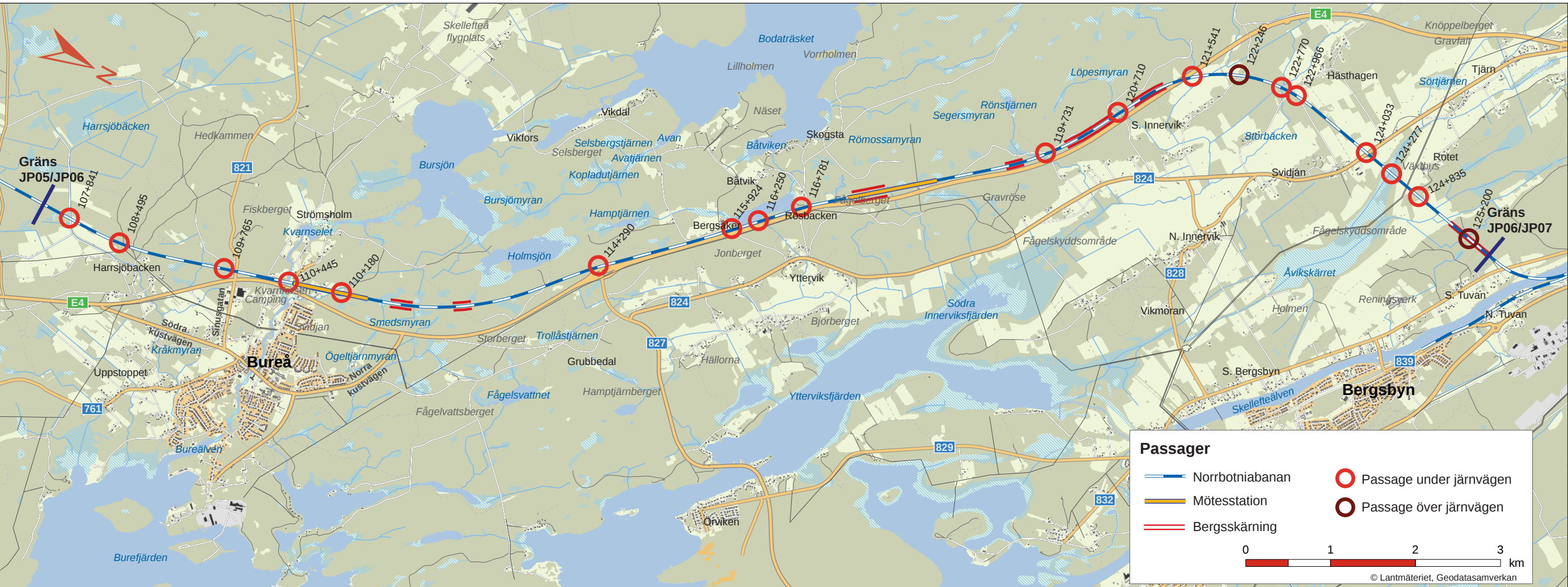
Figur 6.7:1 Inarbetade åtgärder för att minska järnvägens barriärverkan.
