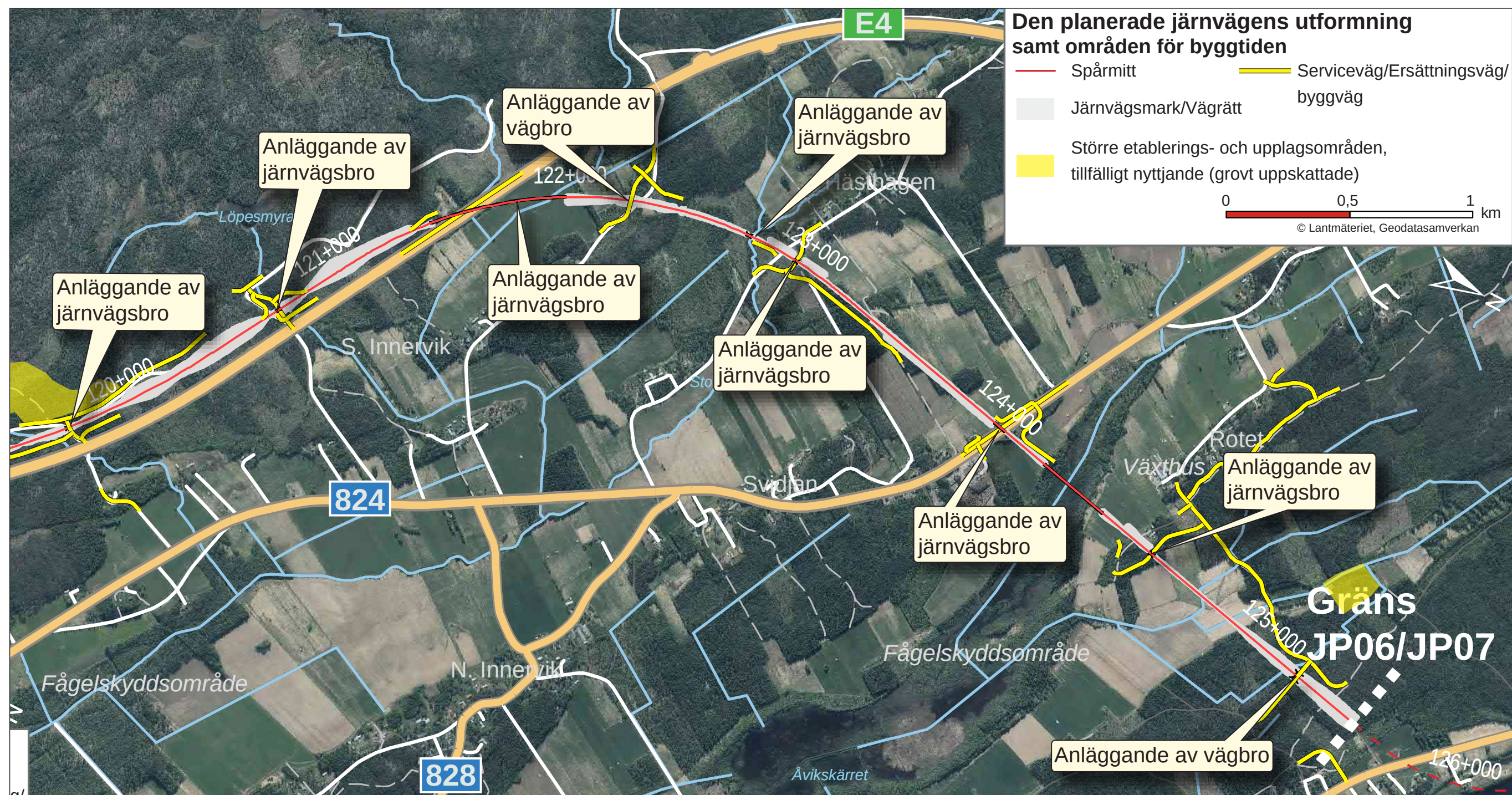
Figur 5.2:18 Den planerade järnvägens utformning samt större arbets- och upplagsområden under byggtiden.
