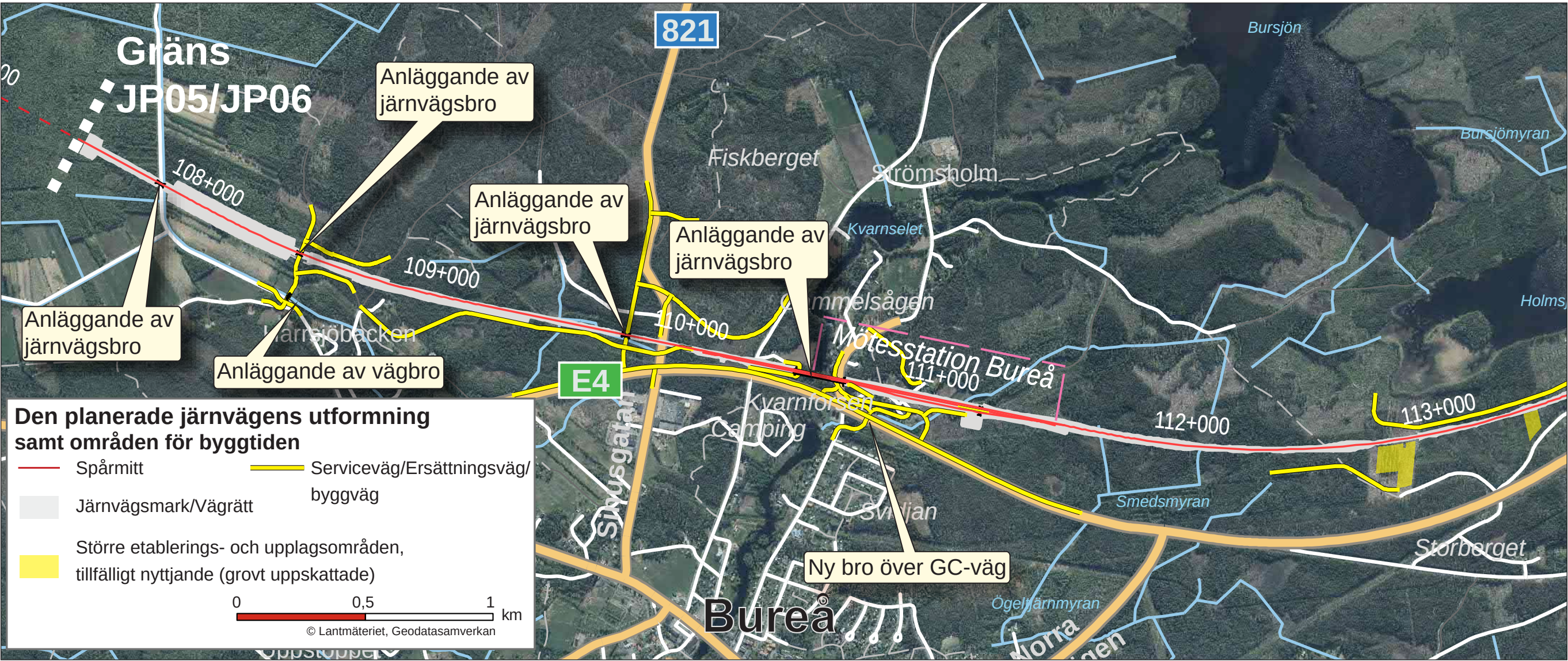
Figur 5.2:16 Den planerade järnvägens utformning samt större arbets- och upplagsområden under byggtiden.
