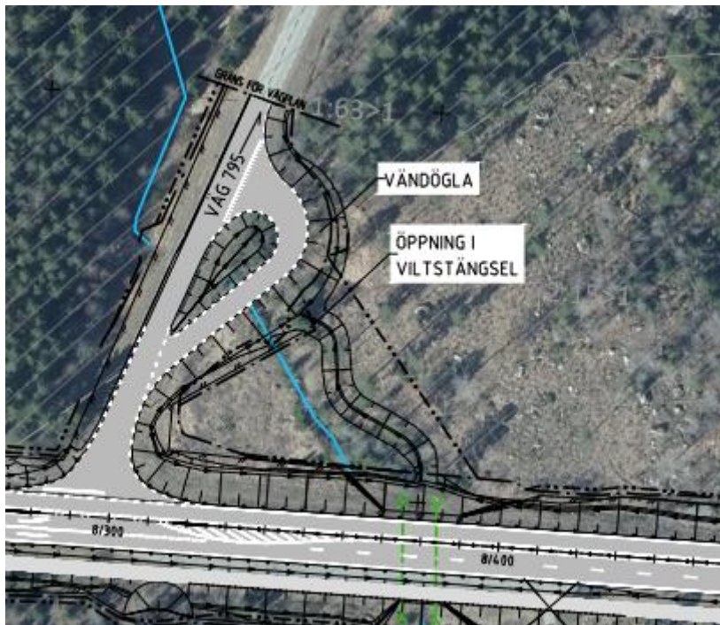
Figur 10 Omgrävning av dike på norra sidan om väg 56.
