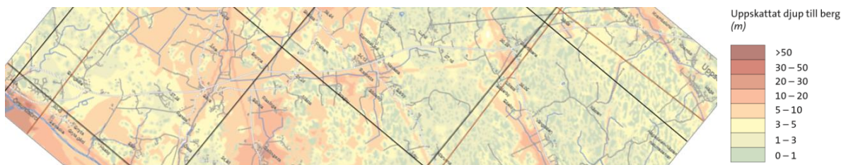
Figur 5. SGU geologiska kartor som redovisar jorddjup längs aktuell sträckning.
