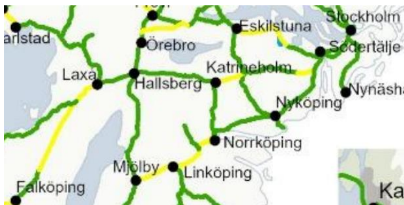
Bild 2: Kapacitetsutnyttjande från utförd trafik under ett vardagsmedeldygn 2021. Rött = högt kapacitetsutnyttjande, Gul = medelhögt kapacitetsutnyttjande, Grön = lågt kapacitetsutnyttjande
