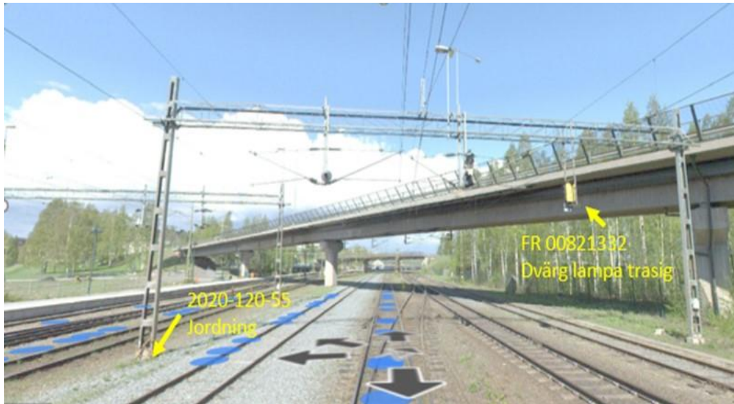
Figur 7.2.4.3. Exempel på hur en användare kan betrakta verkligheten med överlagrad digital information.
