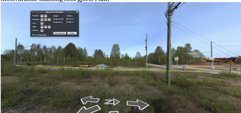
Figur 7.1.5 Vägövergång i Murjek, avstånd mellan väg och kontaktledningsstolpe.
