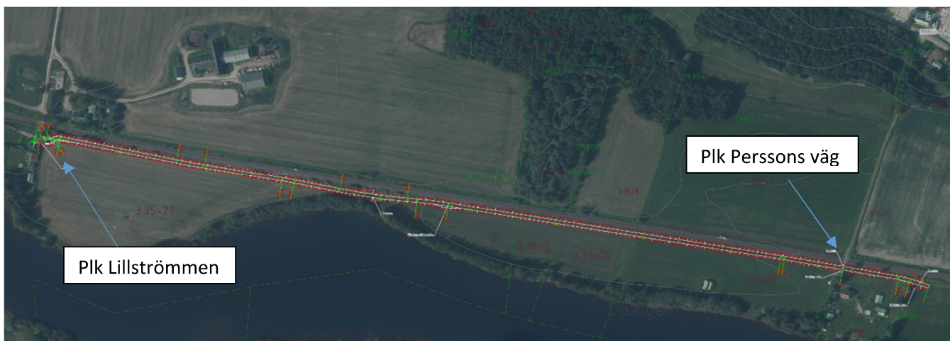
Figur 4. Föreslagen förläggning av ersättningsväg
