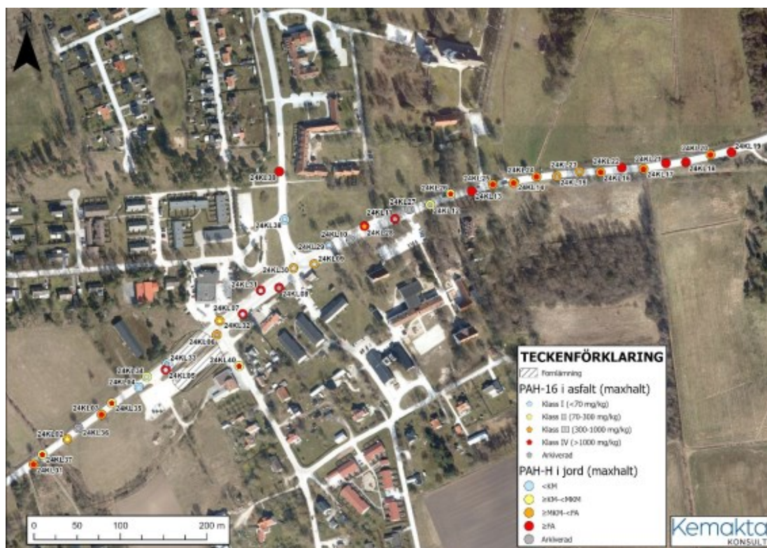
Figur 43 Maximal uppmätt halt av PAH-16 i asfalt (mg/kg) samt maximal haltklass av PAH-H.
