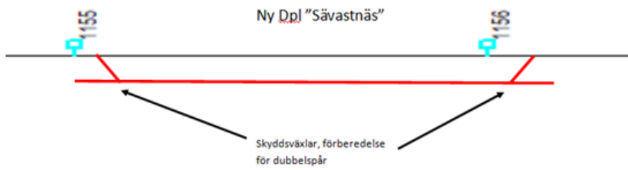
Figur 13. Skiss av planerade åtgärder. Rött, tillkommande anläggning för ny mötesstation inklusive skyddsväxlar.
