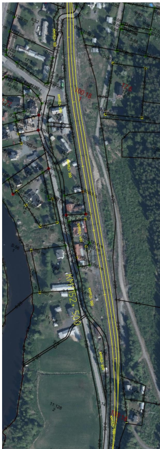
Figur 16. Översikt över dubbelspårsutbyggnaden. Den vänstra bilden visar utbyggnad av dubbelspår norr om Häradsvägen, turkost prickad linje. Den högra bilden visar de tre befintliga spåren vid Sävast där de två vänstra bildar det nya dubbelspåret och spåret längst till höger tas bort.
