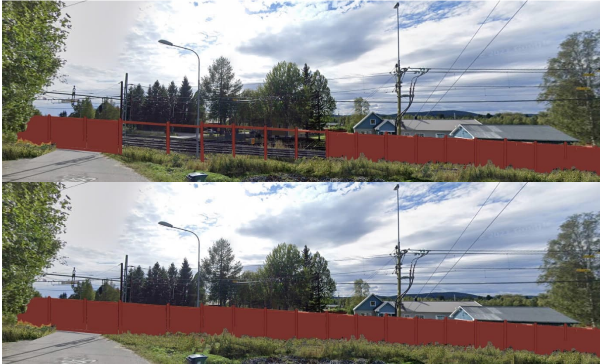
Figur 23. Fotomontage vid plankorsningen Gamla Sävastvägen/Häradsvägen, vid den övre bilden är det inslag av transparenta paneler, den undre har inte det. Omfattning av transparenta paneler bestäms av bullerskyddskärmens dämpande förmåga.
