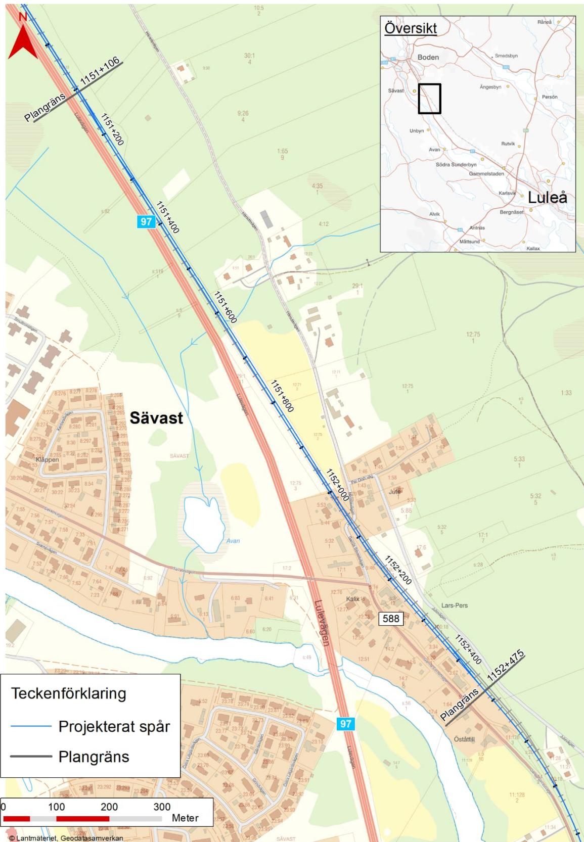
Figur 1. Planerad partiellt dubbelspår på sträckan Sävastklinten-Sävast.
