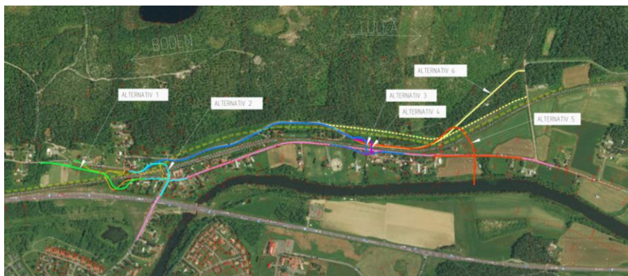
Figur 12. Alternativa sträckningar av vägpassage 1-6.
