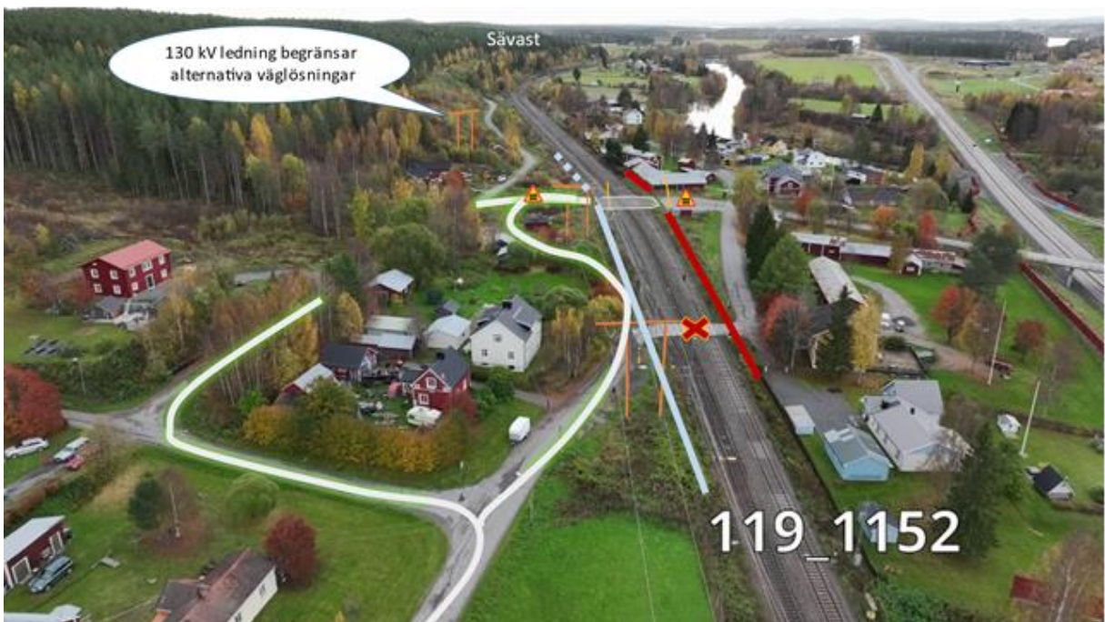
Figur 22 Fotografi från nordväst som visar vart den nya plankorsningen förläggs, samt hur vägen planeras att dras om.
