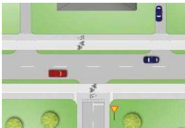
Bild 28. Princip för korsningar med anslutande sidovägar. , (Källa: regional cykelplan för Stockholms län).
