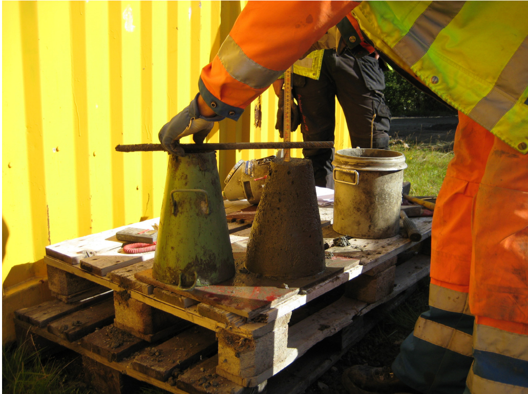
Sättningsmåttaget på arbetsplatsen – i detta fall 31 mm
