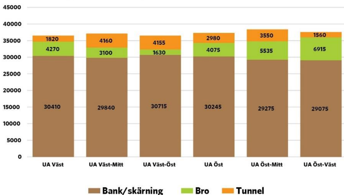
Bank/skärning, järnvägsbro resp -tunnel, meter
