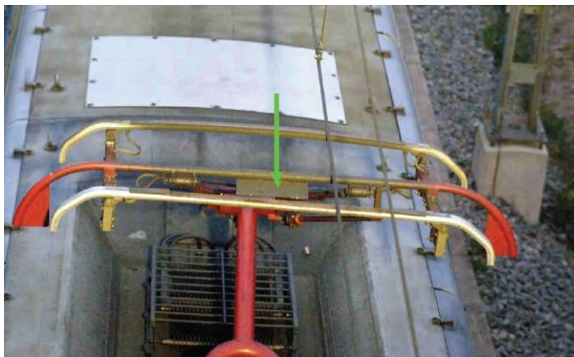
Figur 7: Exempel på bild från kolslitskenedetektor
