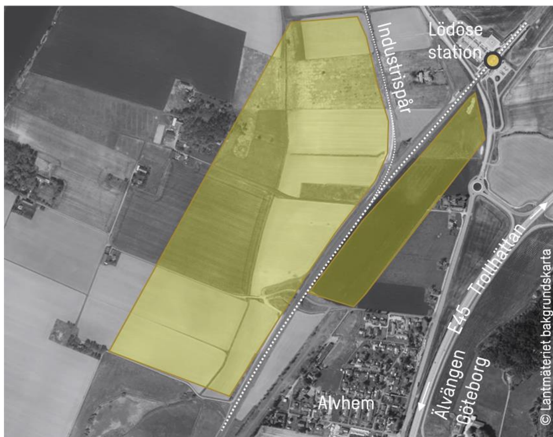
Figur 27 Karta över potentiella platser för uppställningsspår vid Alvhem (Lödöse station). Station (gul) med resandeutbyte till regionaltåg. Yta markerad som gul avser uppställning.
