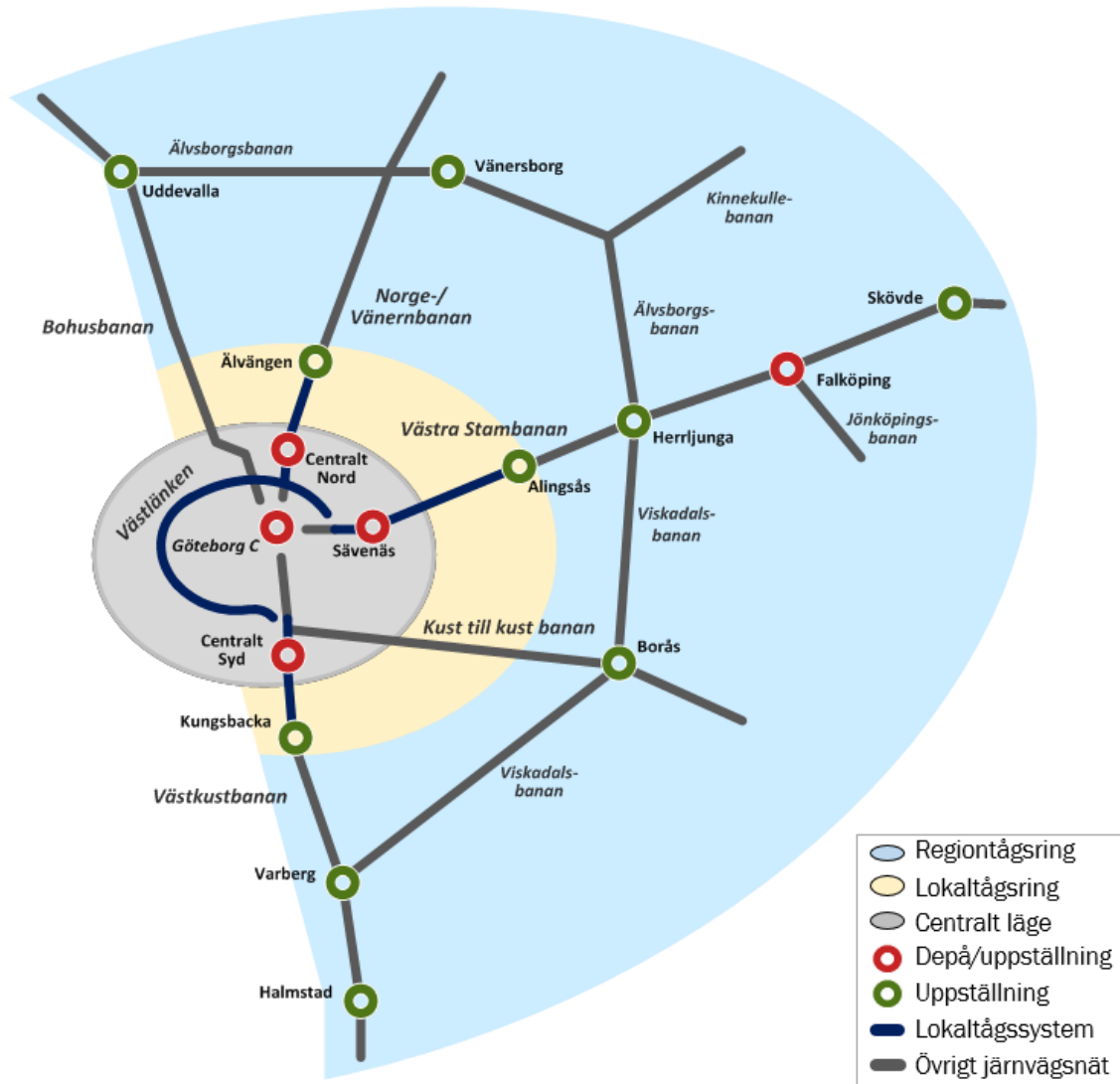
Figur 18 Skiss över uppställningsplatser och depålokaliseringar i principen Centralt/perifer. I detta alternativ föreslås nyetablering av uppställningsspår både centralt, i form av Centralt Nord och Centralt Syd, samt perifert i Älvängen och Kungsbacka. Befintlig uppställning i Alingsås kommer behöva utökas på längre sikt (2030) i detta alternativ.
