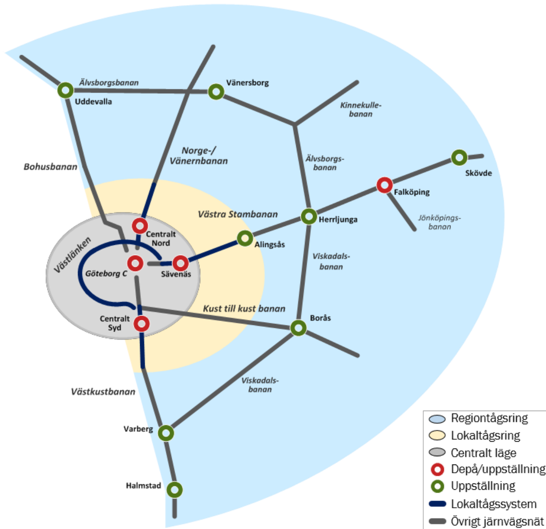
Figur 16 Skiss över uppställningsprincipen Centralt läge. I figuren är det uppställningsplatserna Centralt Nord och Centralt Syd som föreslås etableras. Övriga uppställningsplatser finns redan idag.
