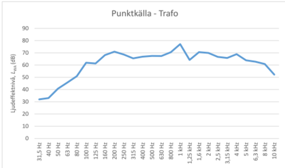
Figur 8 A-vägd ljudeffektnivå i tersband för Trafo inklusive fläktar på tågtag.
