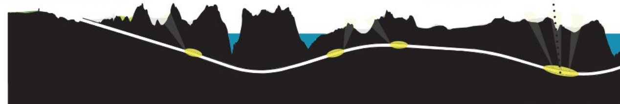
Konceptdiagram: Tunnelprofil södergående tunnel med simulerad dagsljusinstrålning vid trafikplatser och mittrummet "lungan". (Höjd är förstärkt 10 gånger längd).
