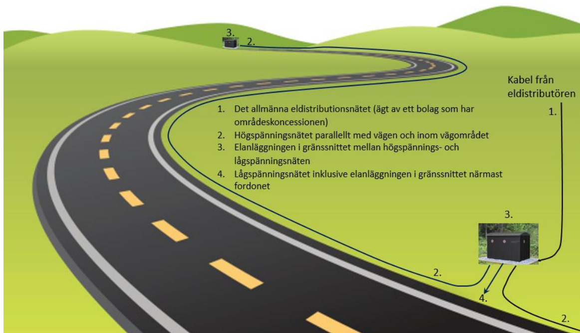
Figur 7. Princip för elförsörjning av elväg
