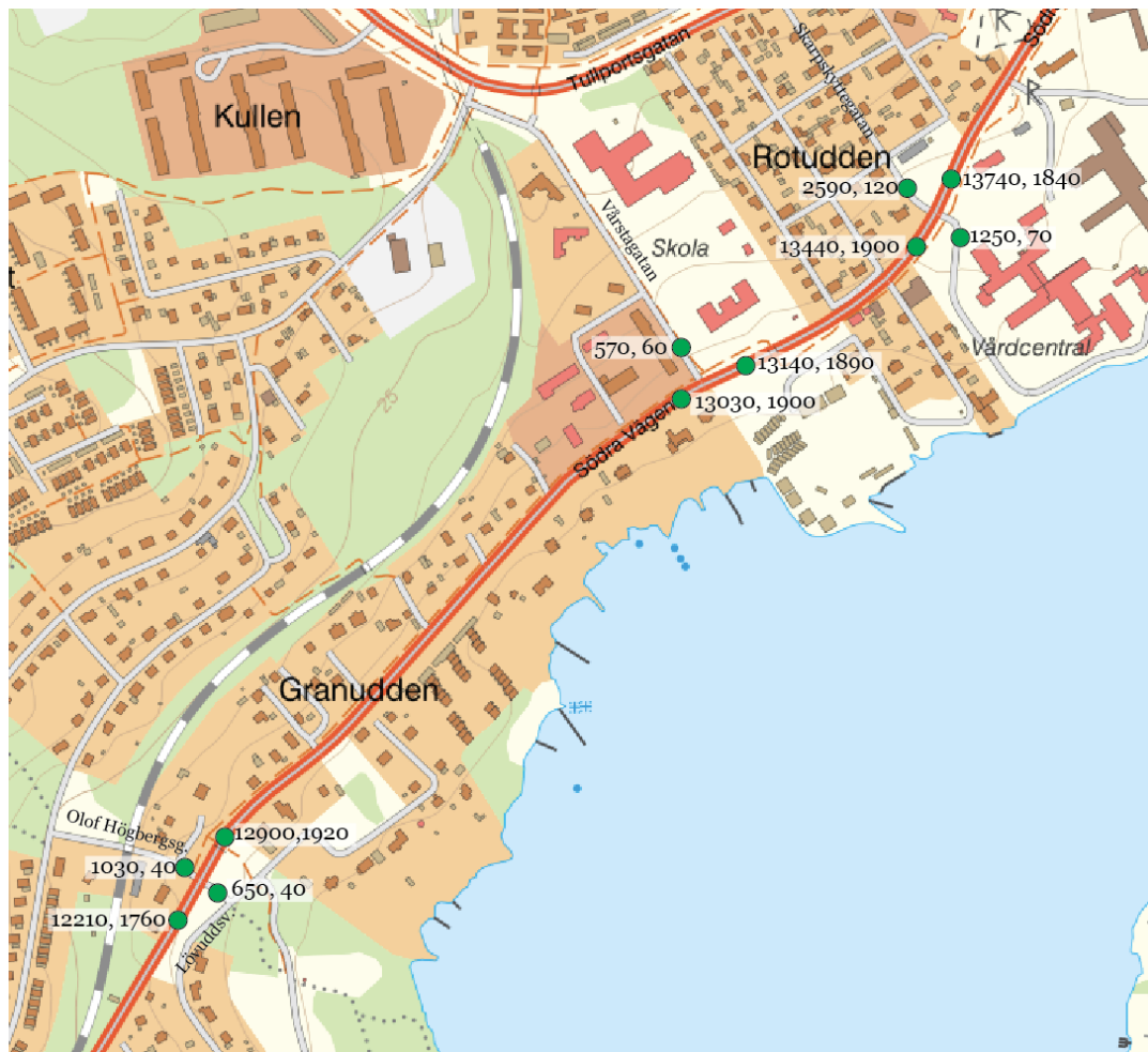
Figur 4.2:1. Bilden visar uppskattat trafikflöde för nuläge år 2021 i enheten ÅDT, årsmedeldygnstrafik. Siffrorna visar totaltrafik, tung trafik. (Kartkälla: Lantmäteriet, Uppräknat trafikflöde för nuläge med underlag från Trafikverkets vägtrafikflödeskarta: https://vtf.trafikverket.se/SeTrafikinformation .)
