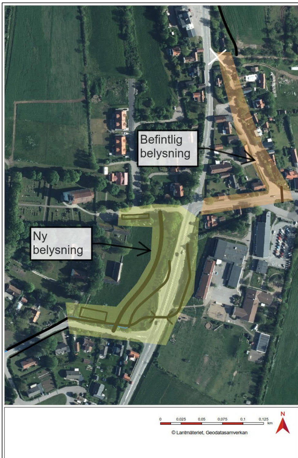
Figur 28. Översikt över föreslagen ny belysning och befintlig belysning som behålls i Glömminge.
