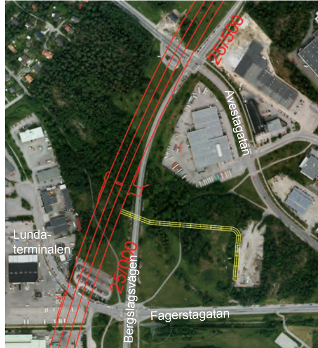
Figur 3.19 Arbetstunnel Lunda (gult). Huvudtunnel visas i rött.
