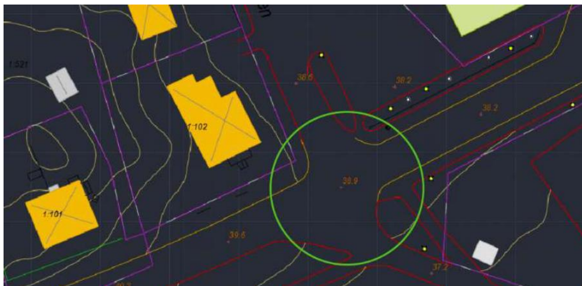
Figur 29. En cirkel med diameter 28 meter ritats in vid korsningen mellan Tungelstavägen och Parkvägen.
